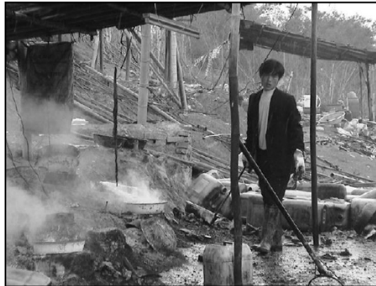
Aquecimento com água regia : mistura ácida altamente tóxica para retirada de pequeníssimas quantidades de ouro. A lama gerada vai diretamente para rio e o gás para os pulmões dos trabalhadores e atmosfera. Guiyu, China, Dez/2001
